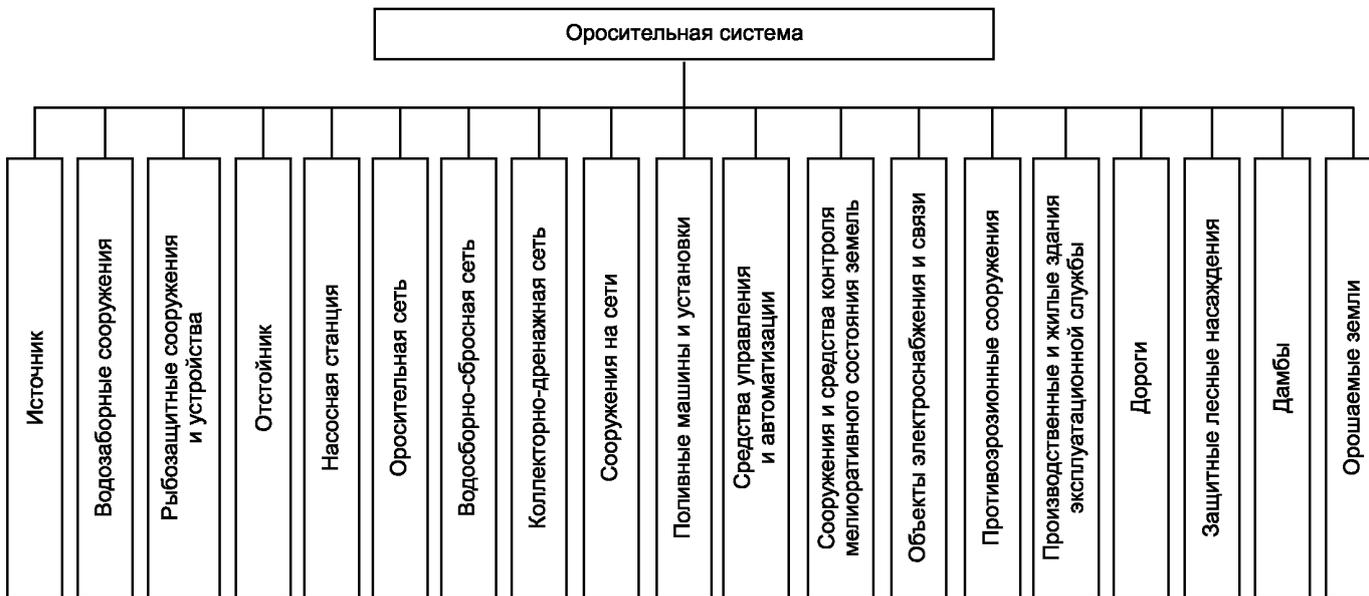
Рисунок А.1 — Состав элементов оросительной системы
