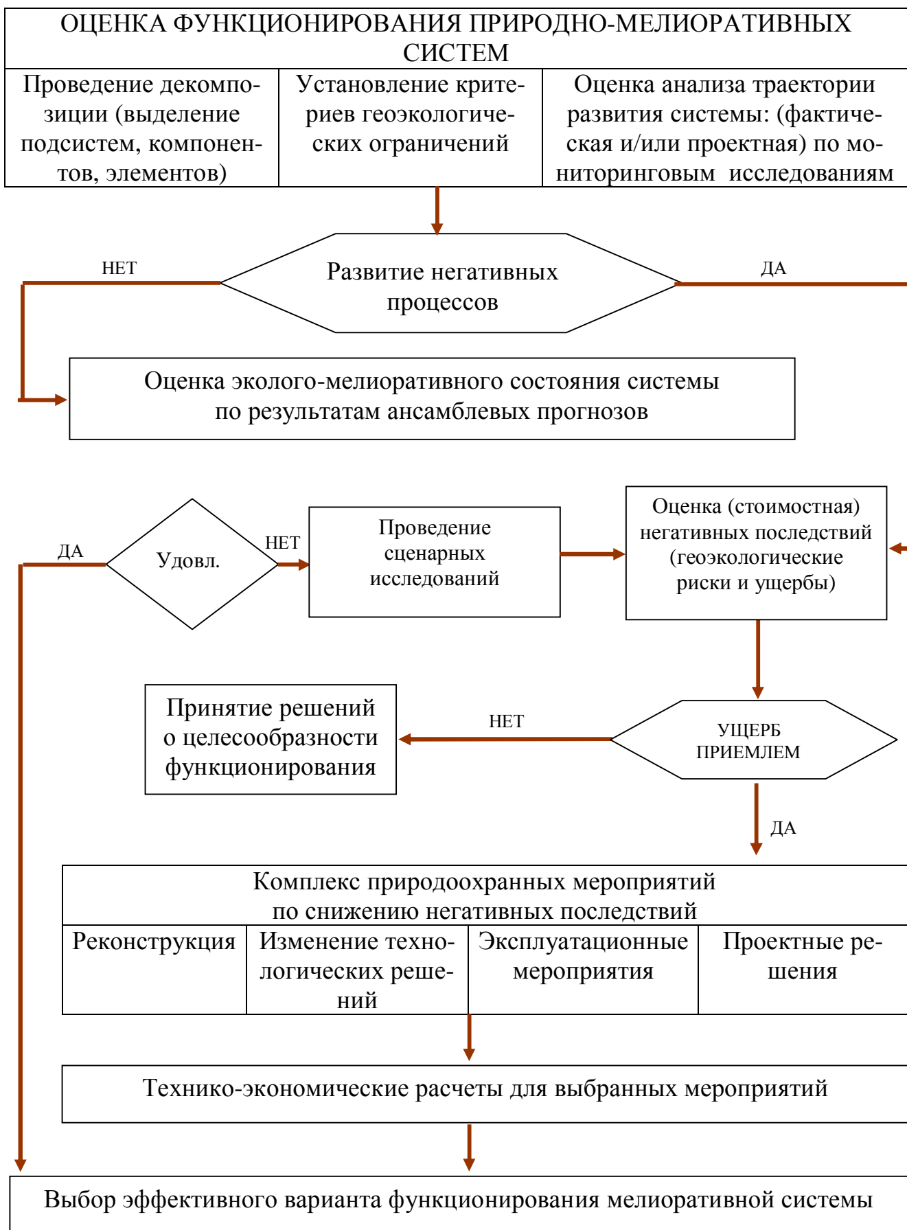
Рис. 1. Обобщенная технологическая схема повышения экологической надежности функционирования мелиоративных систем
