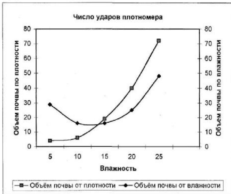
Рис.1. Зависимость сгребаемой с поверхности земель в кучи почвы от ее влажности и плотности
