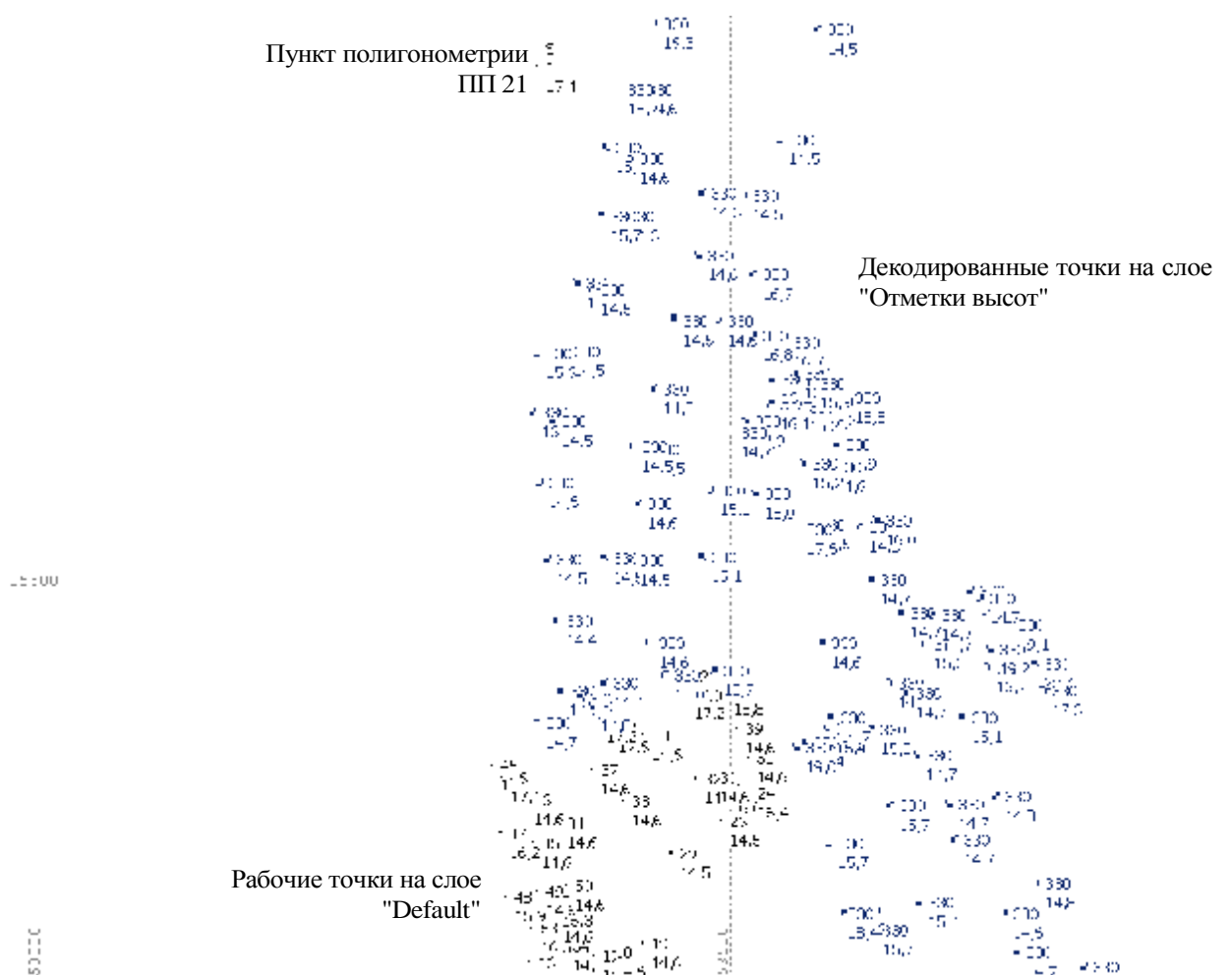
Рис. 1. Плановое распределение рабочих точек тахеометрической съёмки и их частичная постобработка в программе Trimble Geomatics Office
