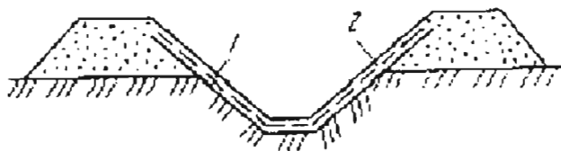
Рис. 100. Антифильтрационная одежда канала из полиэтиленовой пленки: 1- слой пленки; 2- защитный слой грунта
