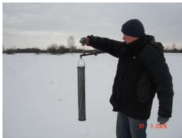
Рисунок 3.5 – Определение высоты и плотности снежного покрова при помощи весового снегомера на стационарном участке наблюдений (пойменные земли АО «Московское», Рязанская область, 2026 год)
