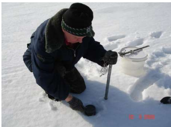
Рисунок 3.5 – Определение высоты и плотности снежного покрова при помощи весового снегомера на стационарном участке наблюдений (пойменные земли АО «Московское», Рязанская область, 2026 год)
