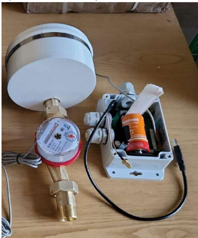
Рисунок 4.2 – Измерительный гидрологический комплекс для регистрации расхода воды в коллекторе
